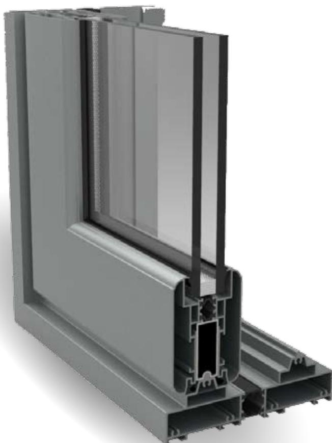
Sistema scorrevole alzante a taglio termico in grado di unire alla qualità estetica dal design classico, telaio con anta scorniciata, le prestazioni di isolamento termo-acustico, di resistenza e di sicurezza grazie alle elevate dimensioni sia del telaio che dell'anta.
